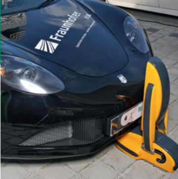
Das induktive Laden von der Vorderseite: Ein neuer Ansatz, der effizient und kostengünstig ist. Foto: Fraunhofer IISB
