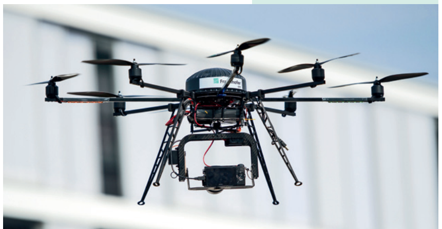
Die acht Rotoren des kleinen Gebäudekontrollators ermöglichen einen Aufstieg über mehr als elf Stockwerke. Foto: Oliver Dietze
