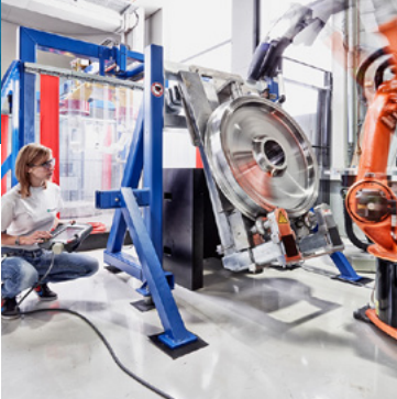
Roboter gestützte Thermographie: Vorhandenes Einsparpotenzial bei Prüfzeiten und -kosten ausschöpfen. © Uwe Bellhäuser
