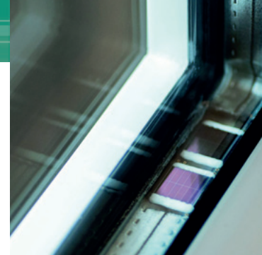
Der im Scheibenzwischenraum angebrachte Chip versorgt sich selbst mit Solarenergie. © Fraunhofer IMS
