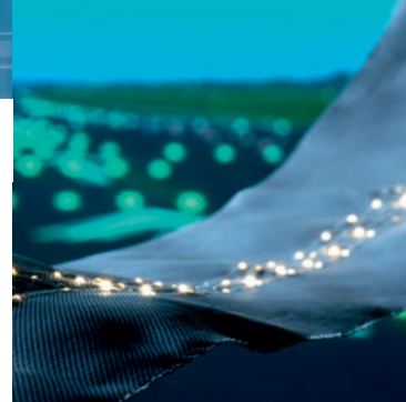
Stoffbahn mit integrierten LEDs. © Fraunhofer EMFT / Bernd Müller
