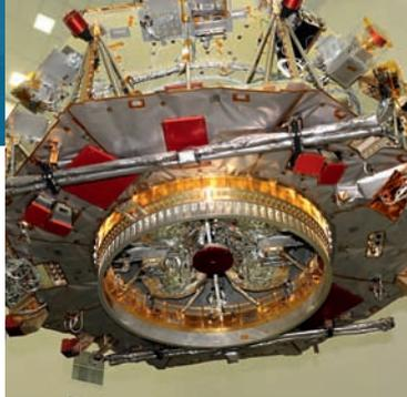
MMS-Satellit mit verschiedenen Messinstrumenten. Das digitale Fluxgate-Magnetometer DFG des Fraunhofer IIS befindet sich an einer der langen Stangen, die ausgeklappt werden können. © SwRI / Ron Black
