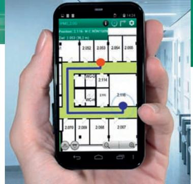
*Sich auch in Gebäuden einfach mit einer Navigations-App orientieren: Fraunhofer-Forscher nutzen dafür die WLAN-Signale in Innenräumen. © Fraunhofer IPMS*
