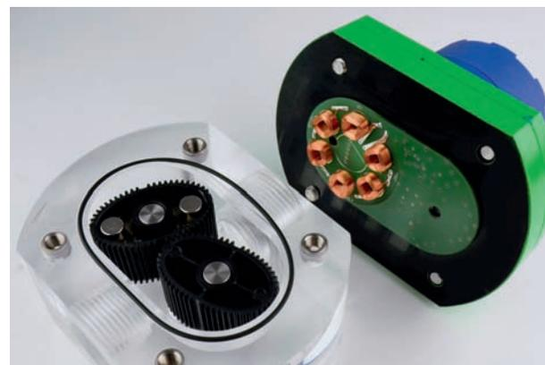
Ovalradzähler ermöglichen eine wartungsfreie Energieversorgung. © Fraunhofer IIS
