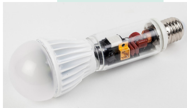
Transistoren aus GaN ermöglichen die kompakte Bauweise dieser zu Schauzwecken auseinandergezogenen Retrofit-LED-Lampe mit 2090 lm. Foto: Fraunhofer IAF
