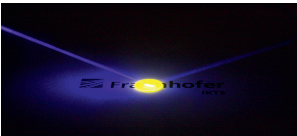
Weiß leuchtende Optokeramik nach Anregung mit blauem Licht (Reflexionsanordnung). Foto: Fraunhofer IKTS
