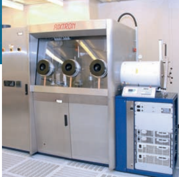
Epitaxieanlage für die Herstellung von Quantenkaskadenlasern mit erhöhter optischer Performance. Foto: Fraunhofer IAF
