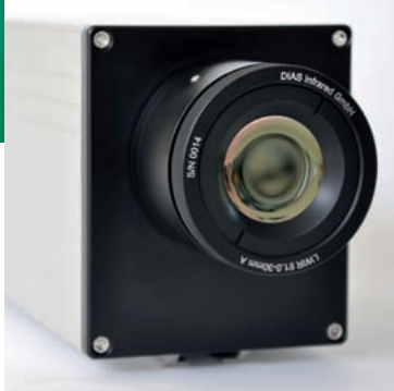
Die neue Testkamera hilft dabei, kleinere, leichtere und energieeffizientere Infrarotgeräte zu bauen. Foto: Fraunhofer IMS
