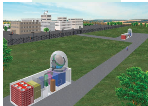
Sowohl die Sende- als auch die Empfangsantenne lassen sich vollständig einfahren. © Fraunhofer FHR
