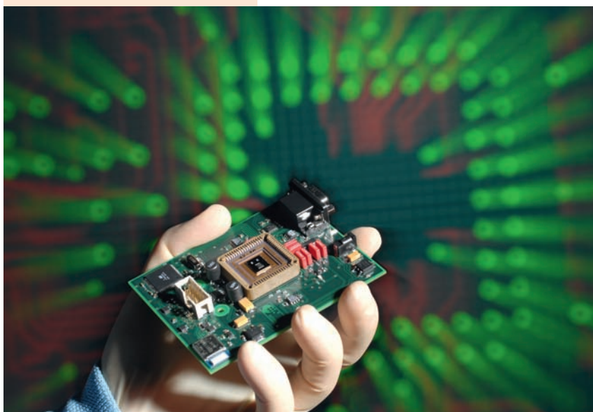
Platine mit Mikrosensor zur Qualitätsmessung der Luft. © MEV Verlag
