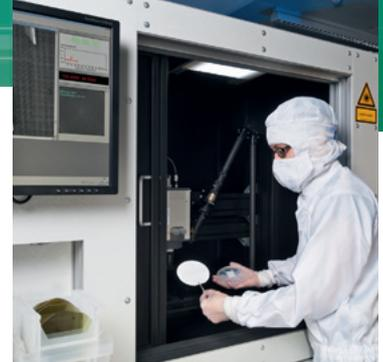
Mit dem neu entwickelten Photolumineszenz-Messsystem lassen sich bereits während der Produktion kleinste Materialfehler in Siliziumkarbid-Wafern nachweisen.
