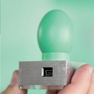
Durch den Einsatz innovativer SiGe-Chip-Technologie ist das Radar für die Entfernungsmessung kompakt, kostengünstig und mit relativ geringem Aufwand zu installieren.
