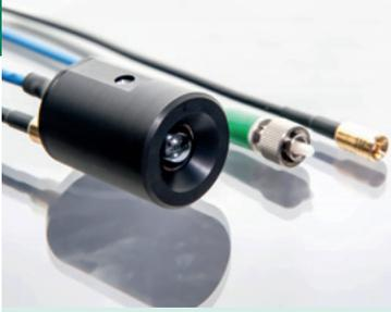
Für den Sensorkopf der Terahertz-Technologie fertigten die Wissenschaftler am Fraunhofer HHI einen Chip, der gleichzeitig senden und empfangen kann, um eine einzige optische Linse nutzen zu können.
