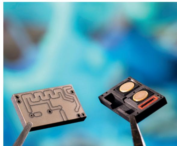
Die Silizium-Mikropumpe ist in der Lage, einen hohen Unterdruck zu erzeugen.
