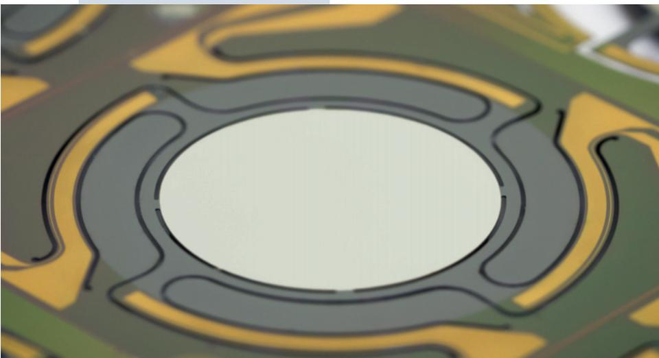
Prototyp eines MEMS-Aktorchips.
