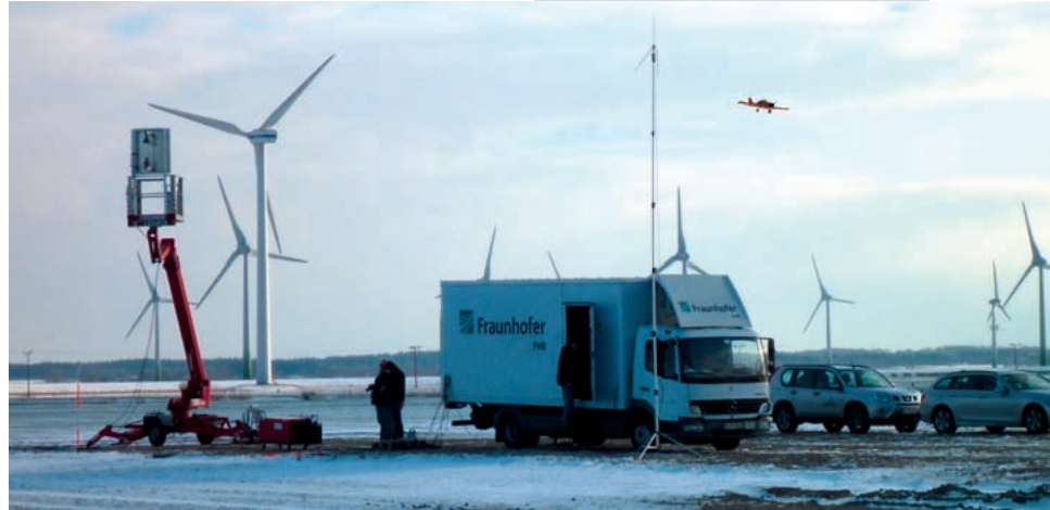
Erste Messungen von Flugzeugen im Windpark mit dem Passiv-Radar-System vom Fraunhofer FHR. Foto: Fraunhofer FHR
