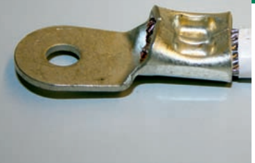
Crimpverbindung mit Kabel. Foto: Fraunhofer IZM / ZVE
