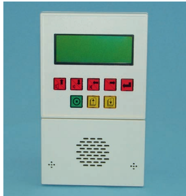
Der intelligente Schallwächter analysiert Lautäußerungen in seiner Umgebung und erkennt so automatisch, wenn ein Notfall vorliegt. Foto: Ilper Elektronik GmbH
