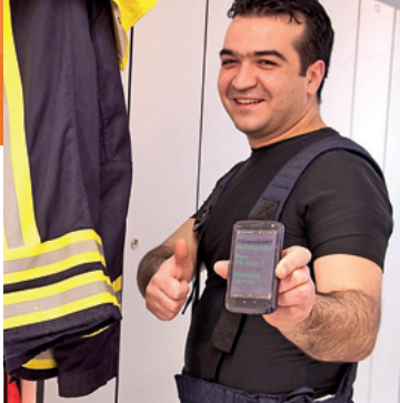
EKG und Atemfrequenz des Feuerwehrmannes werden vom T-SHIRT erfasst und in Echtzeit per Funk übertragen, beispielsweise auf ein Smartphone oder direkt in die Einsatzzentrale. Foto: Fraunhofer IIS
