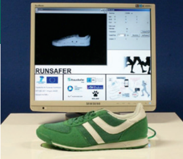
Drahtgebundenes Modell eines Laufschuhs mit eingebauter Sensorik. Foto: Fraunhofer IPMS
