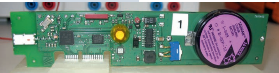
Der Datenlogger gibt Aufschluss darüber, welche Temperaturen und Drücke im Inneren des Fensters herrschen. Foto: Fraunhofer IMS
