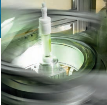
Rotierende Gantry-Variante zur Untersuchung von Flüssigkeitsverteilung im Granulat einer Chromatographiesäule (FAU Erlangen-Nürnberg, Department Chemie- und Bioingenieurwesen). Foto: Fraunhofer EZRT
