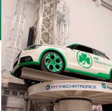
Ein Fahrzeug auf dem riesigen Drehteller des XXL-Computertomographen am Fraunhofer EZRT. Foto: Fraunhofer EZRT / Maik Luxa
