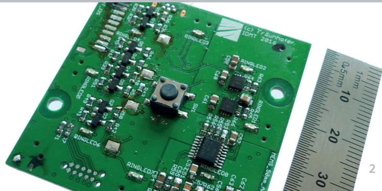
1, 2 Am Fraunhofer IDMT werden Arrays mit einer hohen Anzahl an Mikrofonen für unterschiedlichste Bauformen entwickelt.
