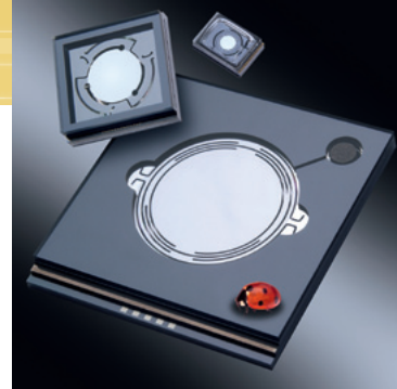
Die schnellen und widerstandsfähigen MEMS-Spiegel lenken den Laserstrahl ab und führen ihn präzise über das Werkstück. Sie halten nun auch hohen Energien stand, sodass sie Aluminium und Stahlbleche bearbeiten können. © Fraunhofer ISIT
