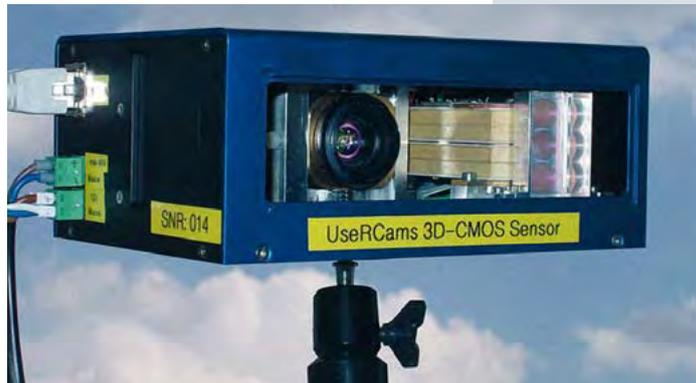
*Die neuartige Kamera ermittelt die Entfernung und dreidimensionale Gestalt eines Objekts. © Fraunhofer IMS*
