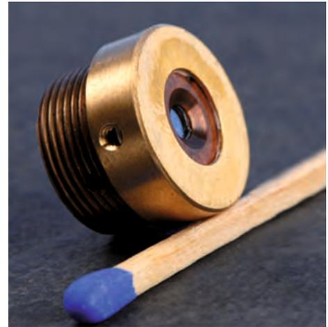
Basis der neuen Lasertechnologie: Ein Halbleiterchip für den Wellenlängenbereich von zwei bis drei Mikrometern, montiert in einem speziellen Kühlkörper. © Fraunhofer IAF
