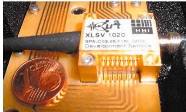
Kompaktes Puls lasermodul mit monolithisch integriertem 40 GHz Puls laserchip sowie angekoppelter Glasfaser (links) und elektrischem Hochfrequenzanschluss (rechts), montiert auf einer elektronischen Steckkarte. Chip herstellung: Fraunhofer HHI, Berlin; Modulaufbau: u2t Photonics AG, Berlin. © Fraunhofer HHI
