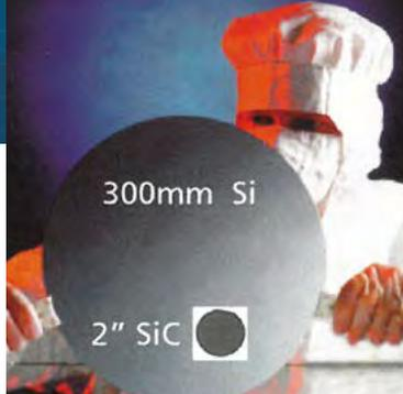
Preislich sind beide vergleichbar: State-of-the-art Silizium- und Siliziumkarbid-Wafer. © Fraunhofer IIS-B (jetzt Fraunhofer IISB)
