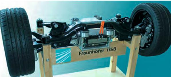
Eine elektrische Hinterachse. © Fraunhofer IISB
