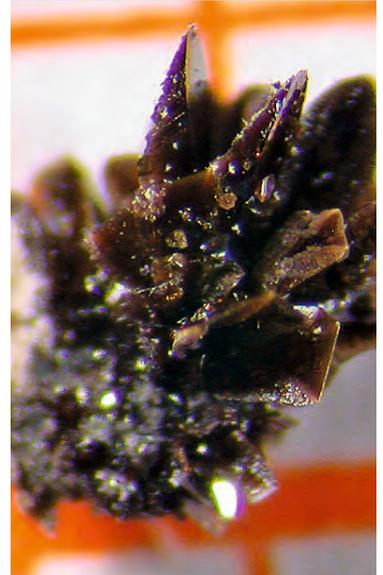
Aus der Gasphase spontan gewachsene GaN-Kristalle. © Fraunhofer IISB
