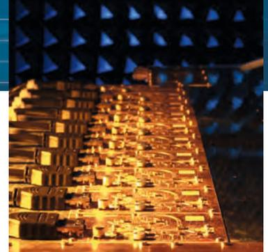
Die Send- und Empfangsmodule der Gruppenantenne sind mit Mixed-Signal-Schaltungen aus Silizium-Germanium ausgestattet.
