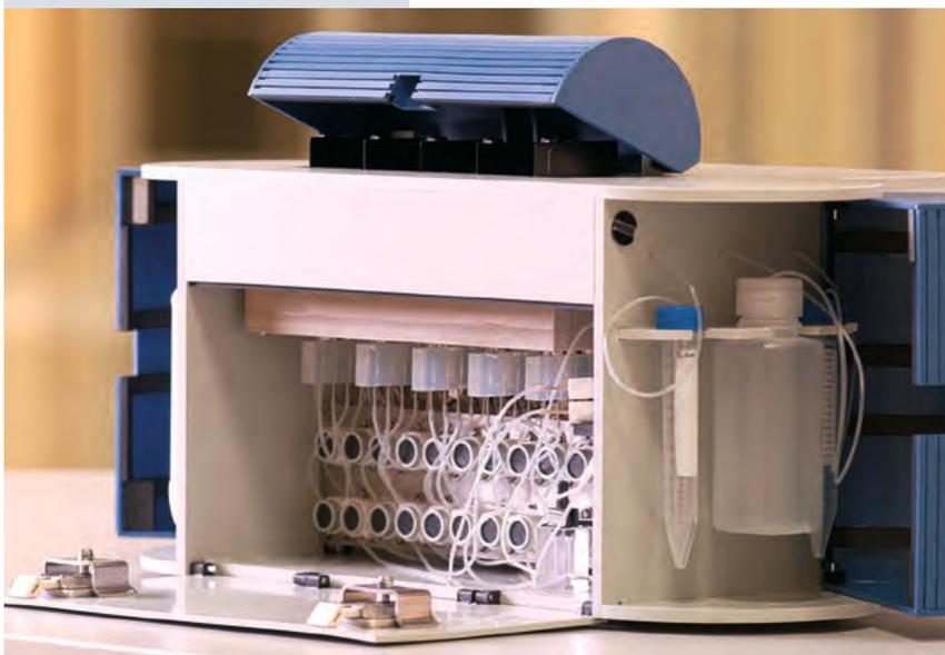
Das fertige »Labor«: Assayprozessor zur vollautomatischen Bearbeitung mehrerer BioChip-Kartuschen.
