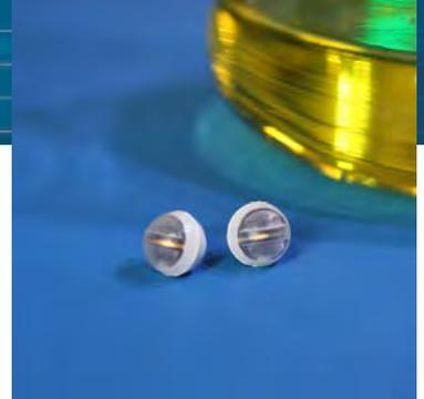
Sens-o-Spheres haben einen Durchmesser von gerade einmal 8 mm. © Fraunhofer ENAS
