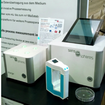
Demonstrator der Sens-o-Spheres: Zu sehen sind das Ladegerät, die Basisstation, die Sensorkugeln in einer Petrischale und ein Handapparat, um die Sphären steril zu applizieren.
