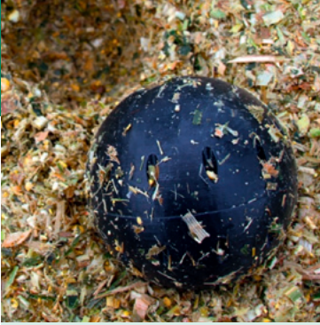
Kugel mit Innenleben: Ein extra robustes Gehäuse schützt die Sensoren vor dem hohen Druck der verdichteten Silage. © Fraunhofer IZM
