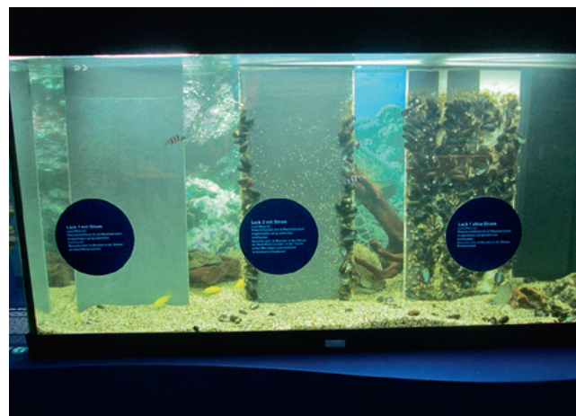
Testschwerter im Versuchsaquarium: Der neue Antifouling-Lack verhindert unter Gleichstrom jeglichen Bewuchs.
