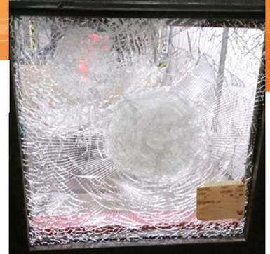
Herkömmliches Sicherheitsglas muss erst brechen, damit der Alarm ausgelöst wird. © Fraunhofer INT
