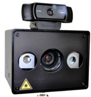
*LiDAR Owl – die Time of Flight-Kamera, die bei Mährobotern zum Einsatz kommen könnte.*
