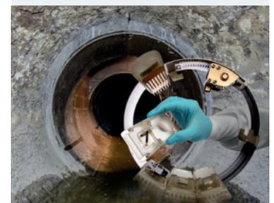
Sensorsystem für die Abwasserüberwachung.
