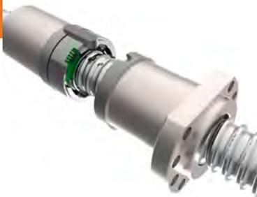
Das Projekt SdSeMa erarbeitet Ansätze für die Strukturintegration von Sensorik – exemplarisch erprobt für einen Kugelgewindetrieb im Anwendungsumfeld einer Werkzeugmaschine. © Fraunhofer IPMS
