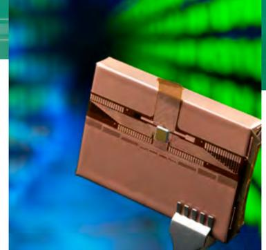
Manipulationsschutzfolie, die um ein Elektronikgehäuse gewickelt wurde.
