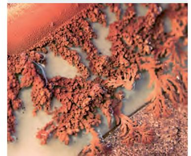
*Korrosionsschutz für leistungselektronische Module. © Fraunhofer IISB
