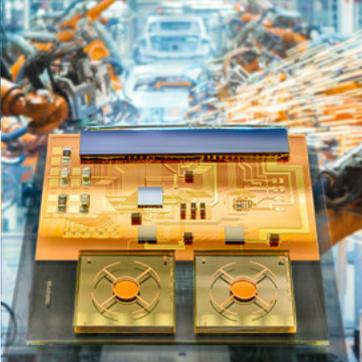
Mobiler Transponder zur Lokalisierung von Werkzeug in einer Industrieumgebung.
