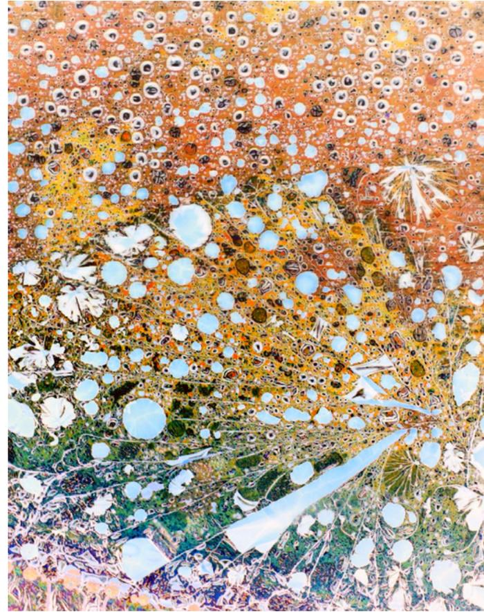
Fällungsprodukte und Dendriten in einem Isoliergraben auf einem keramischen Schaltungsträger (DCB, Direct Copper Bonded Substrat).
