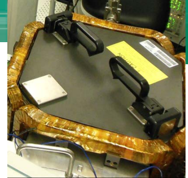
Prozesskammer mit integrierter QCLAS-Diagnostik. © Fraunhofer ENAS
