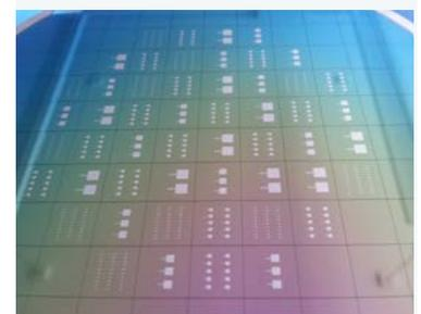
Memristoren für die Rechner von morgen. © Fraunhofer ENAS » Seite 8
