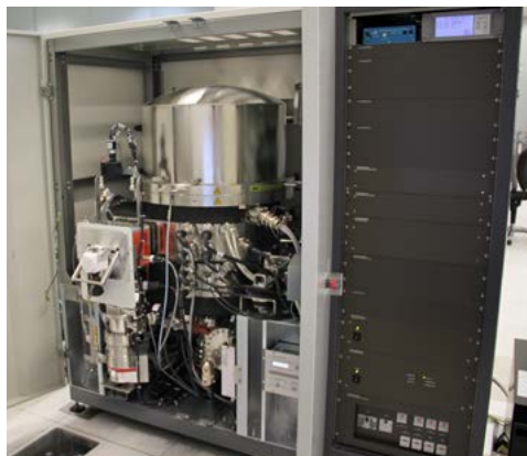
Das Spektrometer wird dazu eingesetzt, die Oberflächen von Siliziumchips zu analysieren und Experimente im Nanobereich zu realisieren. © Fraunhofer IPMS
