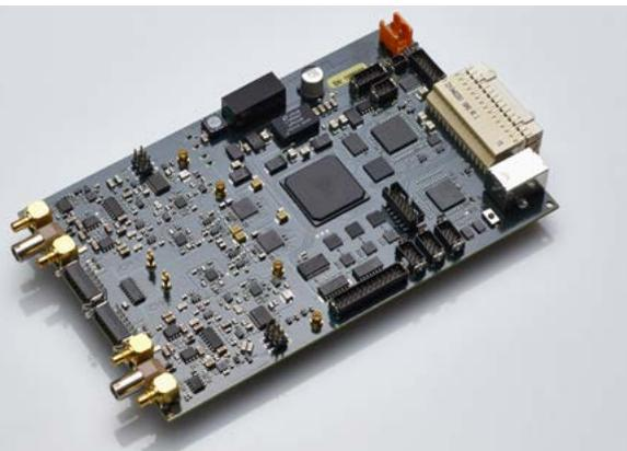
Wirbelstrombaugruppe inspECT-PRO als Teil des Demonstrators. © Fraunhofer IZFP / U. Bellhäuser
