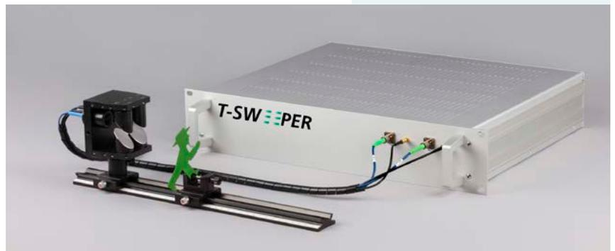
werden können. Ein einfaches Beispiel ist die Bestimmung der Dicke einer Plastikfolie. Diese kann eine Dicke von mehreren 10 µm haben. Mit unserem System können wir innerhalb von wenigen Millisekunden die THz-Reflexionseigenschaften breitbandig erfassen. Von Amplitudenveränderungen bei bestimmten Frequenzen lässt sich dann eindeutig auf die Foliendicke rückschließen. Das gleiche Prinzip gilt für mehrschichtige Proben, wie dem Lackstapel auf einer Autokarosserie.
