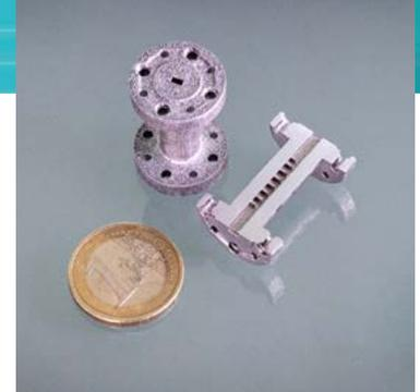
Aus Aluminium gedruckter Hohlleiter-Filter für den Einsatz im Frequenzbereich von 100 GHz. Die Dicke der feinen Lamellen innerhalb des Hohlleiters beträgt ca. 200 µm. © Fraunhofer FHR
