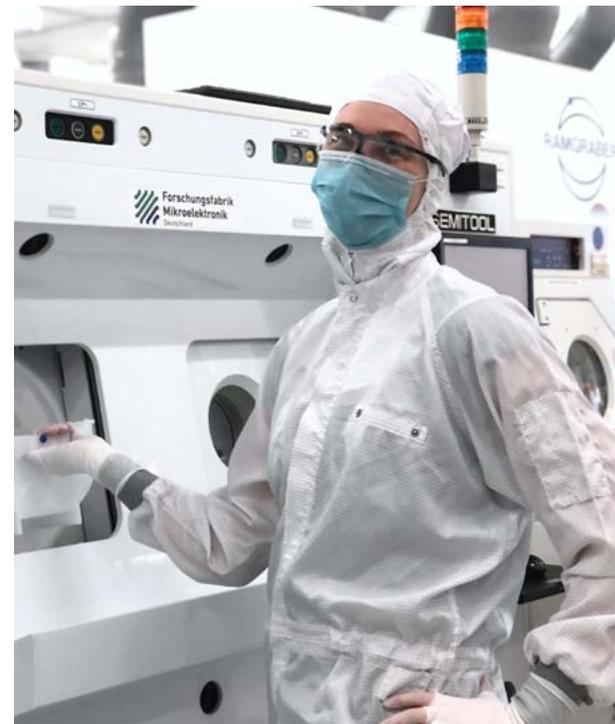
Frau Dr. Wolff bei der Arbeit an der Sprühätzanlage zum Bearbeiten von GaN-Oberflächen im MEMS-Reinraum des Fraunhofer ISIT.
